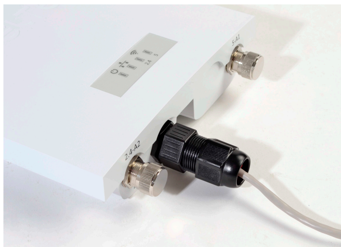
Рисунок 24 – Вид подключенного кабеля к сетевому интерфейсу устройства
