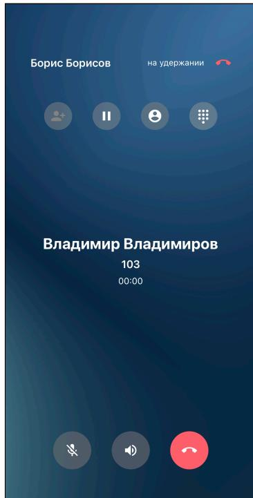
Для переключения на удержаный вызов нужно нажать на него в верхней части экрана вызова. Для завершения удержанного вызова нужно нажать на кнопку
